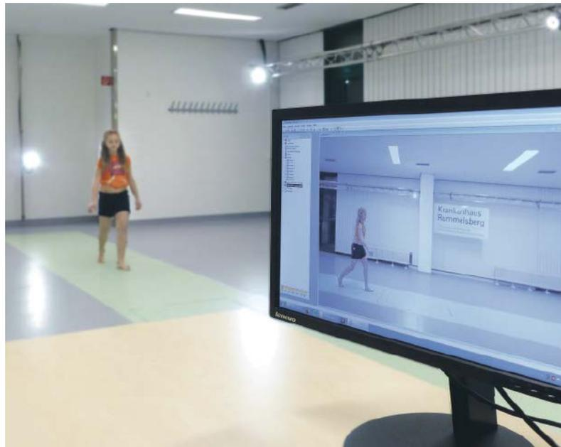
Abb. 1: Einfach, schnell, realistisch: Im bildbasierten System reichen wenige Marker aus, um eine aussagefähige Ganganalyse zu erstellen.
